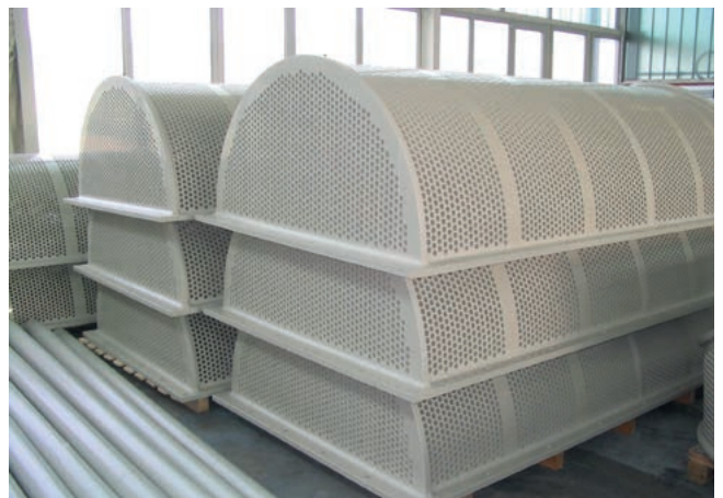
Siebkörbe für Absorber aus Polypropylen (PP)
