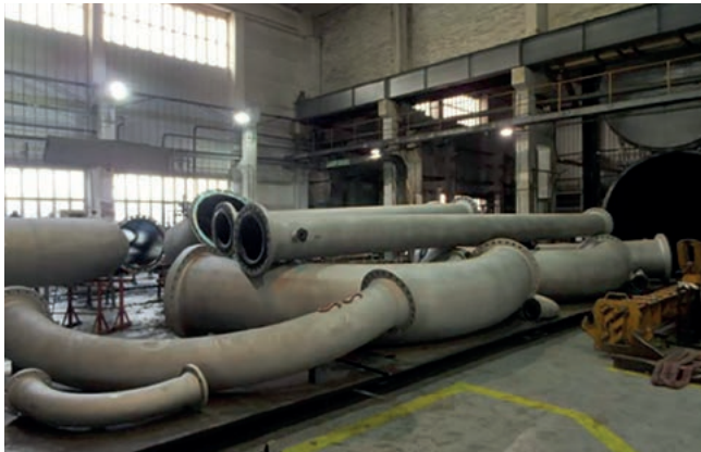
Gummierte Rohrteile nach der Vulkanisation im Autoklav
